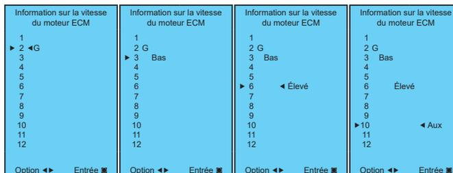
Une fois le réglage de la vitesse de chauffage auxiliaire sélectionné, l'outil AIDE retourne automatiquement à l'écran de configuration du moteur ECM.
