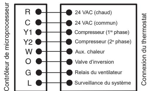
Figure 22 : Câblage du thermostat (signaux de communication)
